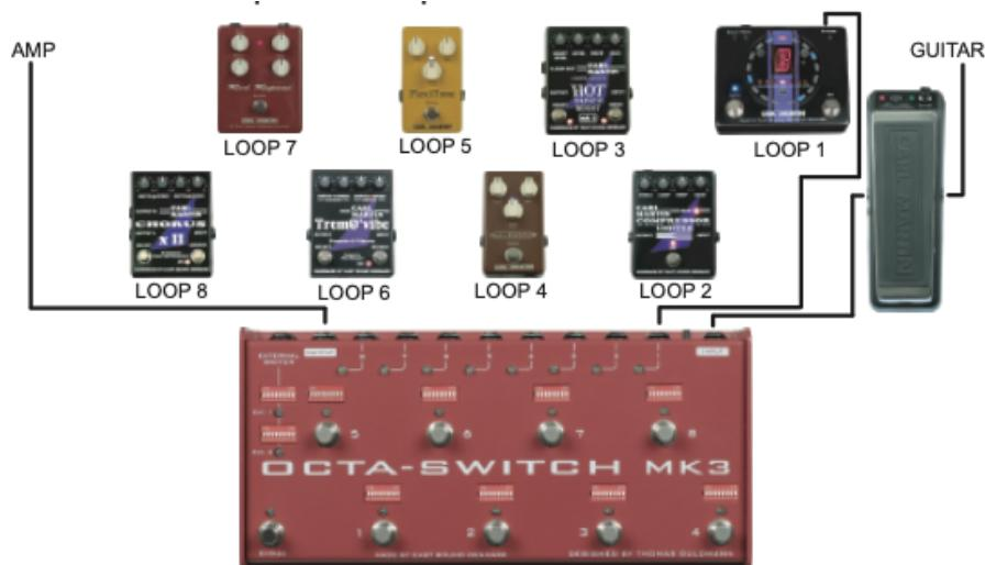
Anslut en stämapparat till t.ex. loop 1 send, och inget i loop return, välj t.ex. program 8 med endast loop 1 aktiverad, på detta sätt stänger du av systemet medan du får signal till din stämapparat, utan att signalen passerar genom stämapparaten.
