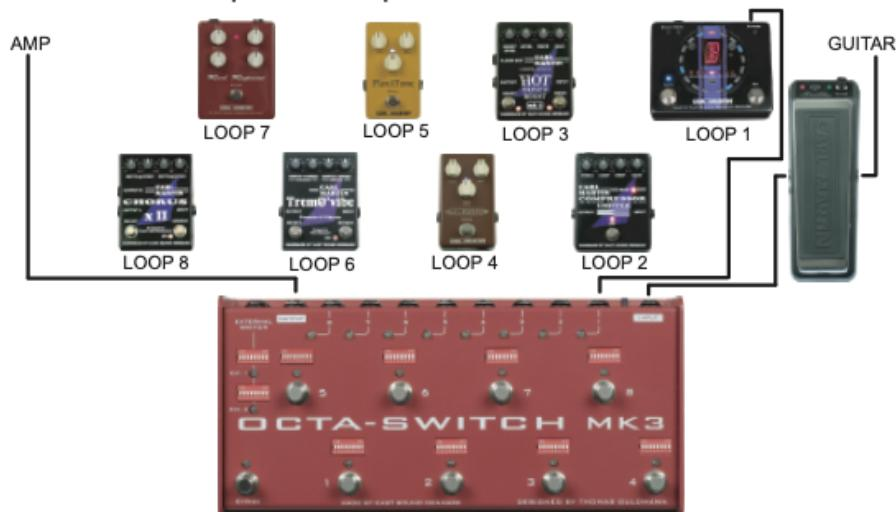
Tilslut en tuner til f.eks. loop 1 send, og intet i loop return, vælg f.eks. program 8 med kun loop 1 aktiveret, på denne måde dæmper du systemet, mens du får signal til din tuner uden at signalet passerer gennem tuneren.
