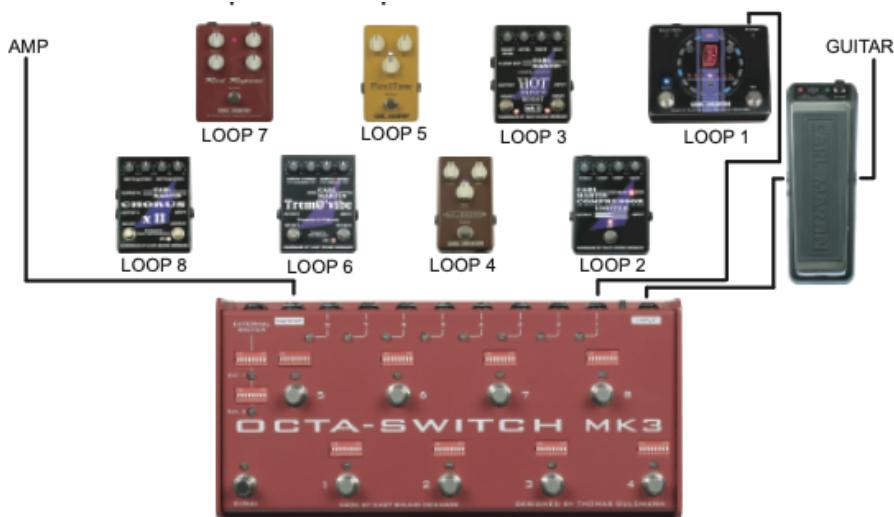
Conecta un afinador a, por ejemplo, el envío del loop 1, y nada en el retorno del loop, selecciona, por ejemplo, el programa 8 con solo el loop 1 activado, de esta manera silencias el sistema mientras obtienes señal para tu afinador, sin que la señal pase a través del afinador.
