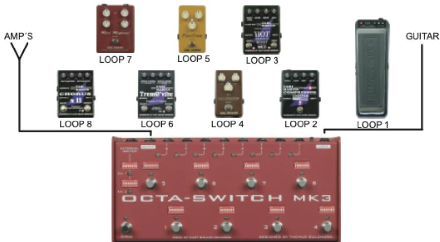
Verwende ein Y-Kabel im linken Ausgang mit 2 Mono- und 1 Stereo-Klinkenstecker, verbinde Spitze & Ring mit (+)
