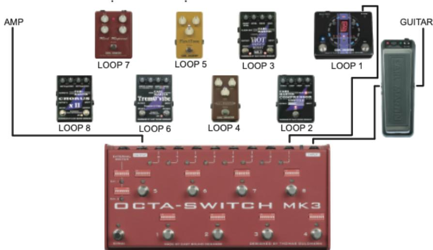
Collega un accordatore a cioè il send del loop 1, e nulla nel return del loop, seleziona cioè il programma 8 con solo il loop 1 attivato, in questo modo muti il sistema mentre invii il segnale al tuo accordatore, senza che il segnale passi attraverso l'accordatore.
