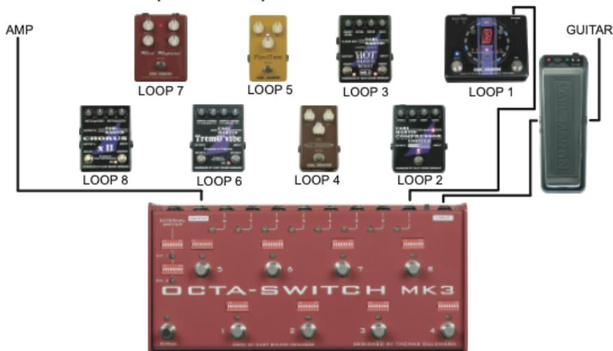
Koble en tuner til f.eks. loop 1 send, og ingenting i loop return, velg f.eks. program 8 med kun loop 1 aktivert, på denne måten demper du systemet mens du får signal til tuneren din, uten at signalet går gjennom tuneren.
