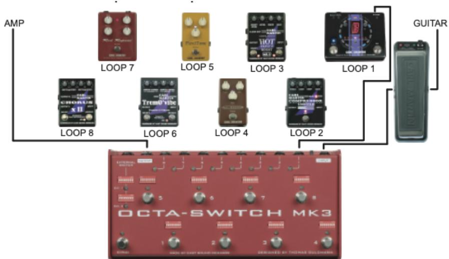
Connectez un accordeur à, par exemple, l'envoi de la boucle 1, et rien dans le retour de la boucle, sélectionnez, par exemple, le programme 8 avec seulement la boucle 1 engagée, de cette façon vous coupez le système tout en envoyant le signal à votre accordeur, sans que le signal ne passe par l'accordeur.
