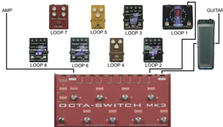
Verbind een tuner met bijvoorbeeld loop 1 send, en niets in de loop return, selecteer bijvoorbeeld programma 8 met alleen loop 1 ingeschakeld, op deze manier demp je het systeem terwijl je signaal naar je tuner krijgt, zonder dat het signaal door de tuner gaat.
