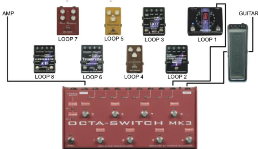
Schließe einen Tuner an z.B. Loop 1 Send an und nichts im Loop Return, wähle z.B. Programm 8 mit nur Loop 1 aktiviert, auf diese Weise stummst du das System, während du Signal zu deinem Tuner erhältst, ohne dass das Signal durch den Tuner geht.
